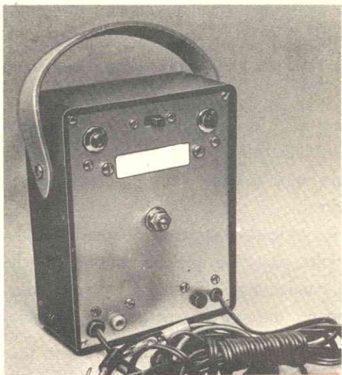
Il prototipo dell'apparecchio è stato montato entro una scatola di plastica, dotata di un manico che ne facilita il trasporto.
