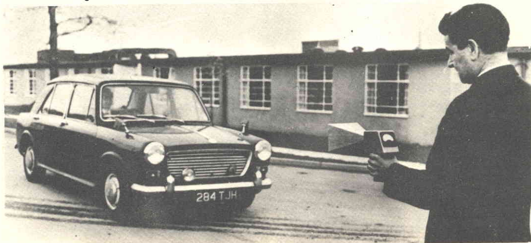
Fig. 4 - Tachimetro radar miniatura mentre misura la velocità di un'autovettura.
